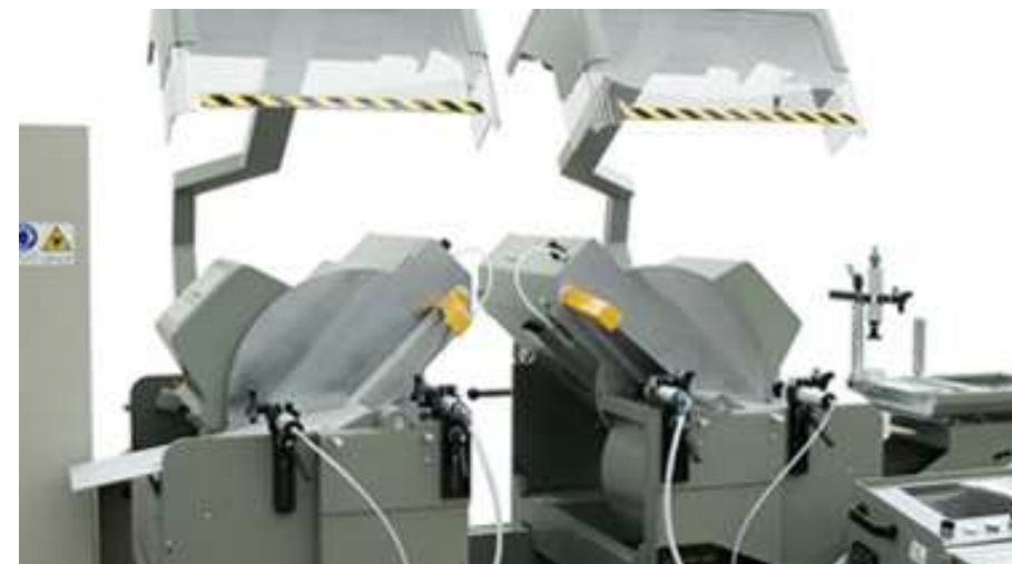
Pivotement électrique des têtes de sciage
